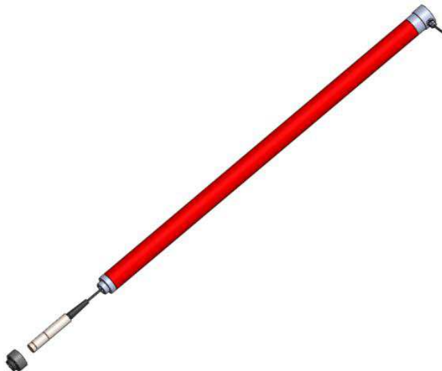
Widok rozłożony uchwytu sondy i czujnika
